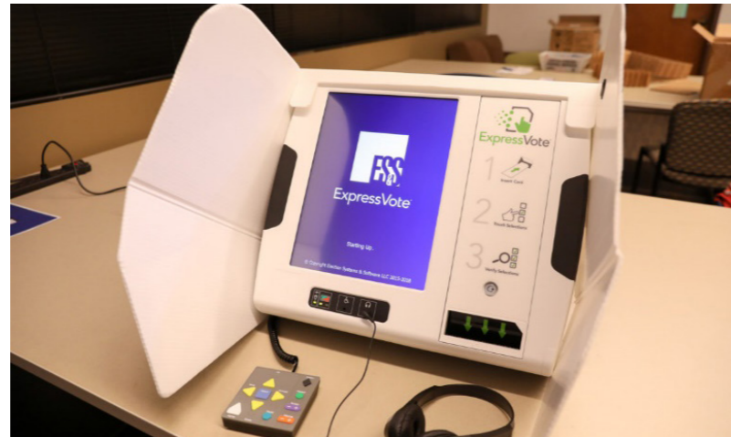
Електронний пристрій для маркування, ExpressVote. Після маркування роздруковує бюлетень у вигляді чека, що містить інформацію про зроблений вибір буквами та у вигляді штрих-коду.
